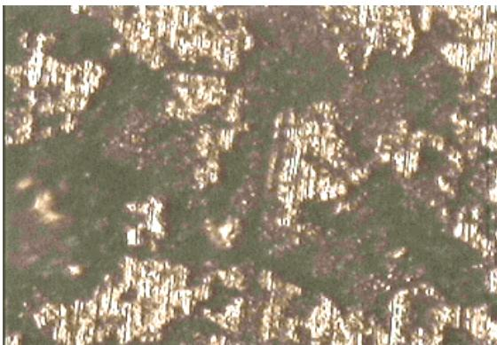
الشكل (8) طبوغرافية سطح عينة معاملة محلوليا بدرجة (500C°) معرضة لوسط تاكملي (3% HCl) في درجة حرارة (80C°) بقوة تكبير (600X)
