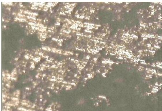
الشكل (4) طبوغرافية سطح عينة غير معاملة حراريا معرضة لوسط التاكل (3% HCl) (80°C) في درجة حرارة (80°C)
