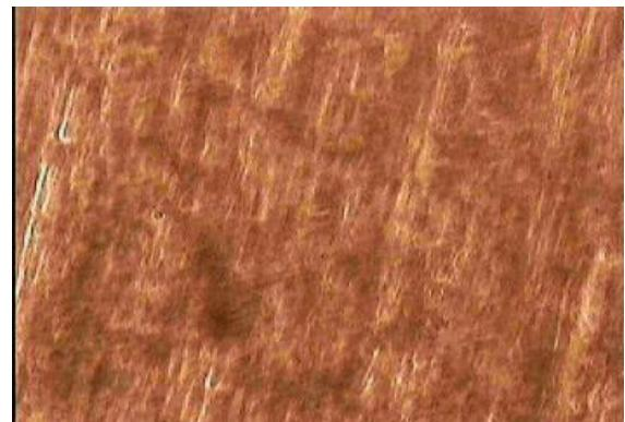
الشكل (3) طبوغرافية سطح عينة غير معاملة حراريا بقوة تكبير (600X)
